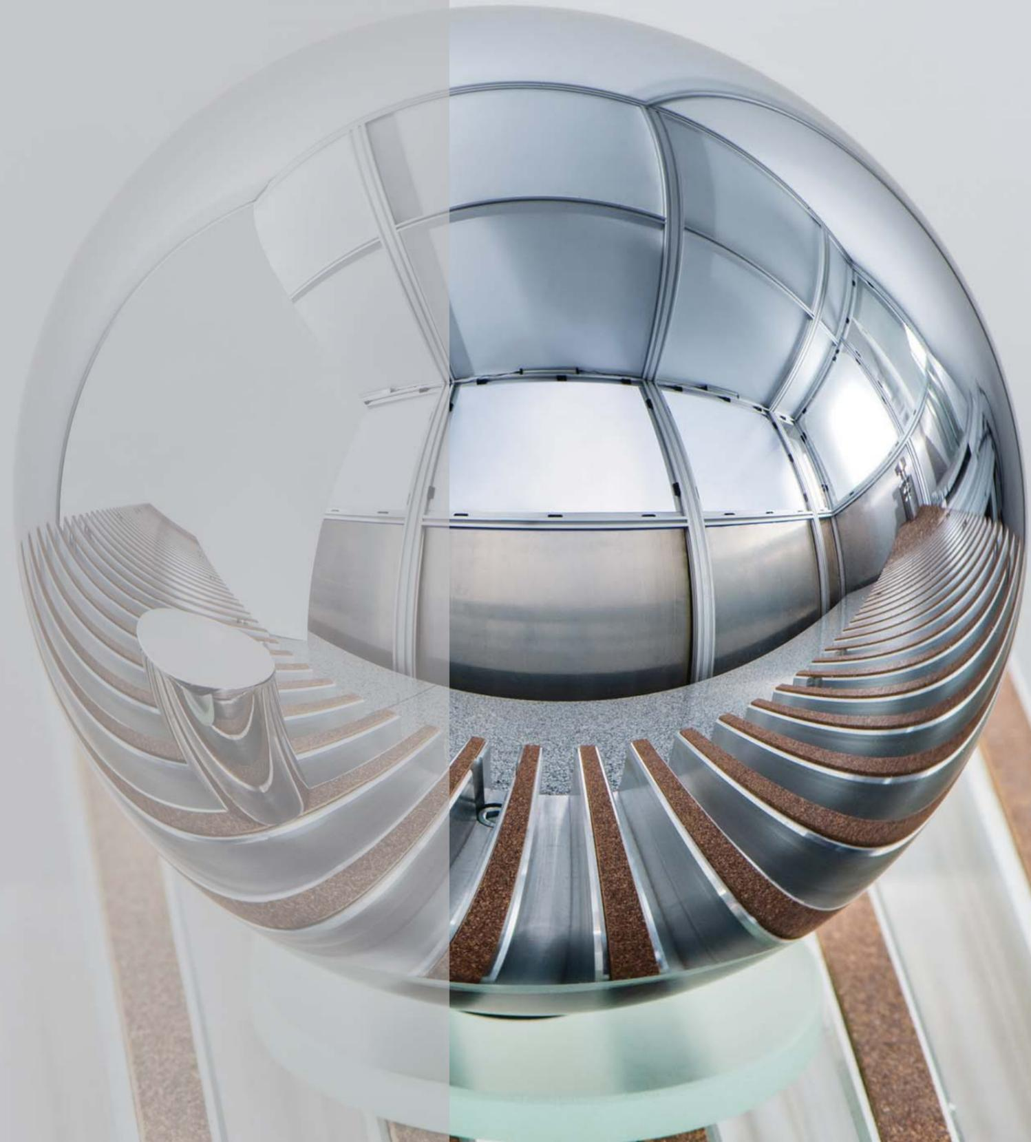
Abb.39: Die Siliciumkugel als neue Darstellung des Kilogramms.
