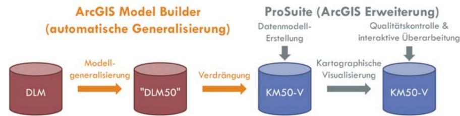
Abb.24: Schema des Produktionsprozesses für KM50-V
