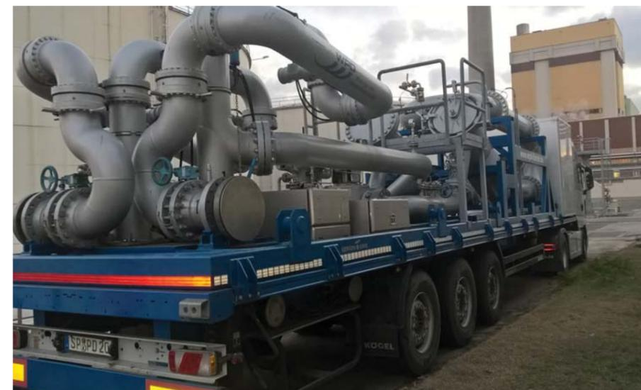
Abb.54: Mobile Zweiweg-Rohrprüfschleife (17m / 2,5m / 4m)
