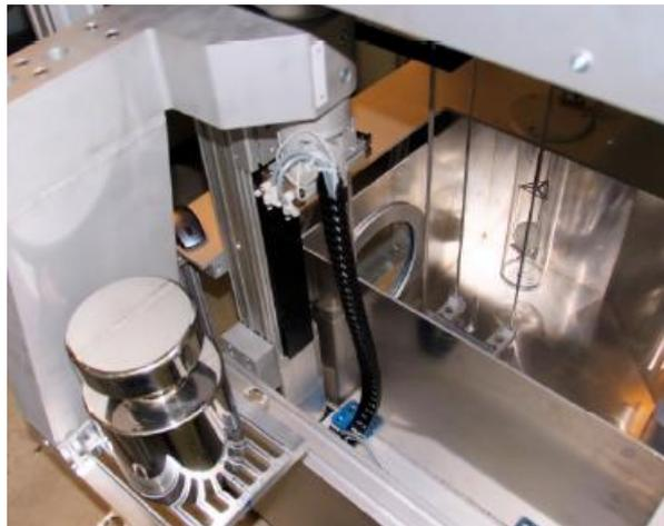
Liftsystem mit einem 50-kg-Prüfungsgewicht; im Hintergrund die Messzelle zur Flüssigkeitsdichtebestimmung; rechts ein spezieller Senkkörper zur Kompensation der Oberflächenbewegung
