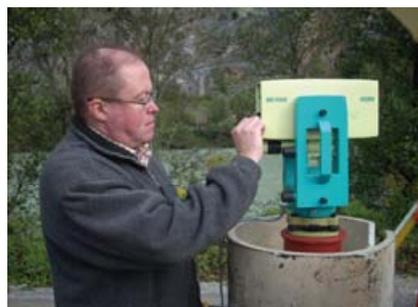
Jorma Jokela vom FGI bei einer von 672 Messungen in Innsbruck geführt. Vier Kalibrierungen wurden auf der Basis von Nummela (Finnland) vor und nach der Übertragung durchgeführt, jede mit insgesamt 240 Messungen. Vier Kalibrierungen wurden an vier Tagen auf der Basis in Innsbruck gemessen, jede mit 168 Messungen.
