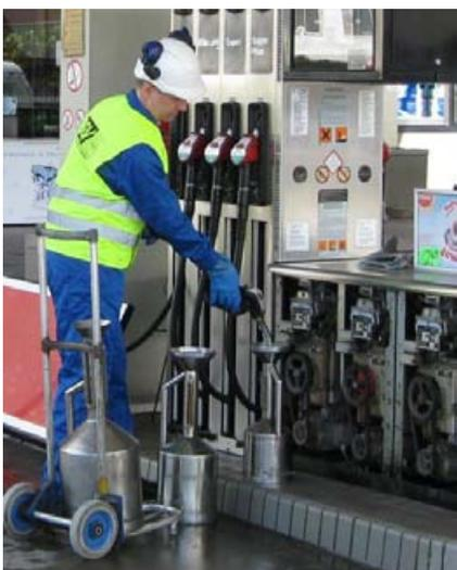
Messtechnische Überprüfung einer Zapfsäule
