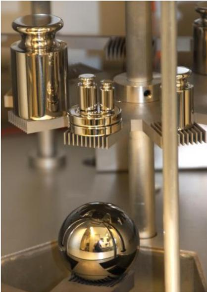
Magazin der Substitutionsgewichte, Einbringvorrichtung mit Silizium-Dichtennormal vor der Einbringung in die Messzelle
