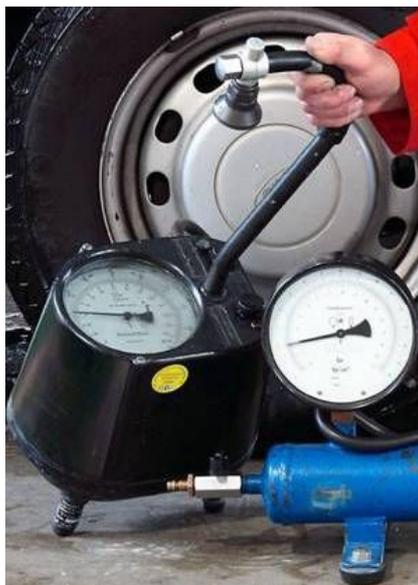
Reifendruckmessgerät bei der messtechnischen Prüfung
