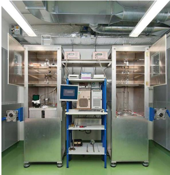
Abb. 1: Hydrostatische Wägung – Nationale Normalgeräte des BEV
