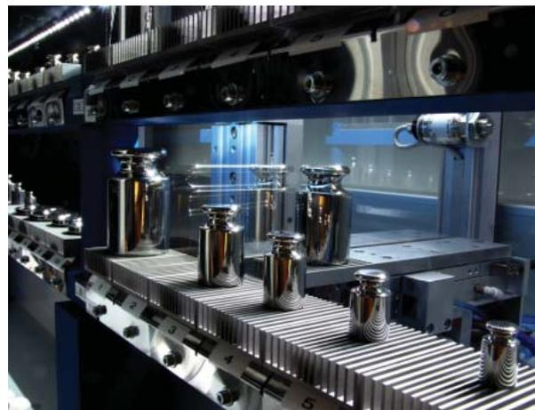
1 kg Massenwechselsystem – hochauflösende Prototypen Waage (Eigenentwicklung BEV und IFT)
