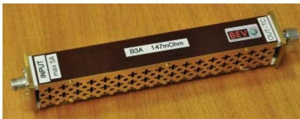
Abb.1: Ausführung des Shunts für einen Messstrom von 5 A
