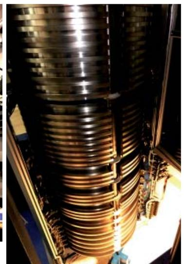
*Gewichtsstapel 5 kN bis 100 kN mit Auflagen, Waagengehängen und Schwingungsdämpfung*
