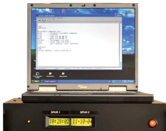
Messeinheit der Geschwindigkeits-Messstelle des BEV
