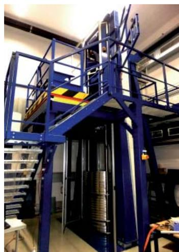
*Anlagenteil bis 250 kN (Arbeitsplattform in 3,5 m Höhe, kann auf 5 m Höhe gefahren werden), Gewichtsstapel 5 t (50 kN) und 10 t (100 kN) sind sichtbar*
