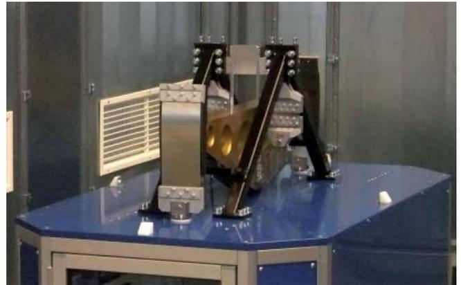
*Realisierung der Balkenwaage: Waagensystem der Anlage 2 kN mit Festkörperlager*
