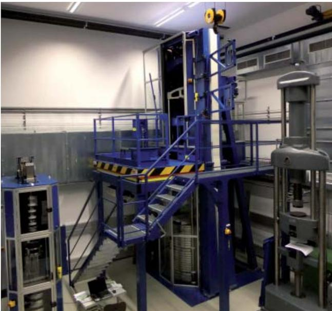
*Gesamtanlage: links Anlagenteil bis 2 kN, Mitte Anlagenteil bis 250 kN und rechts 1 MN Hydraulikmaschine*
