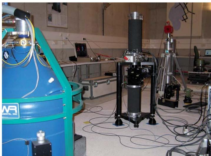
Abb. 4: GWR, FG5 und JILAg bei Vergleichsmessungen am Conrad-Observatorium
