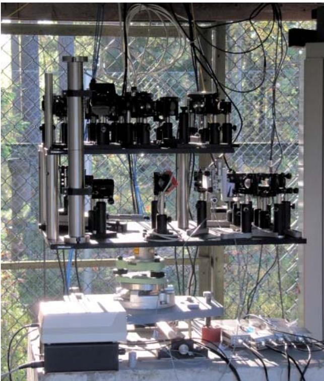
Interferometerkopf auf einem Messpfeiler der Präzisionsreferenzstrecke Nummela
