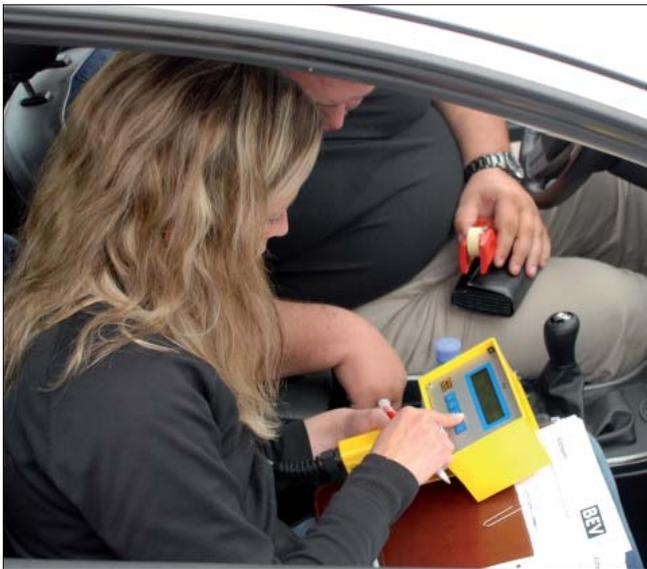
Revision eines Fahrpreisanzeigers mit messtechnischer Kontrolle
