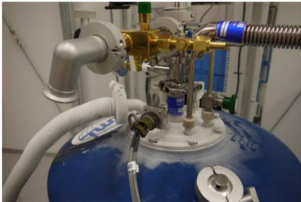
Abb. 1: Kryostat mit eingebautem Messrohr
