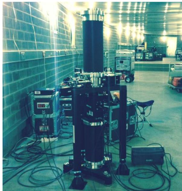
Abb.3: Das AG FG5-242 des BEV bei der Key-Comparison CCM.G-K2 in Walferdange, Luxemburg
