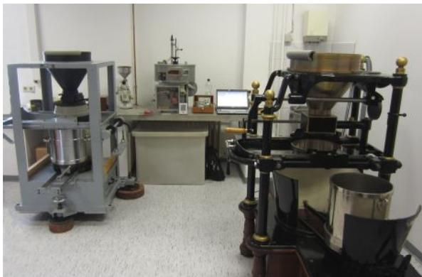
*Links das Normalgerät der PTB und rechts das BEV-Gerät während der Vergleichsmessungen*
