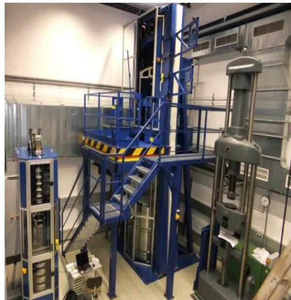
Realisierung der Systeme: 2 kN und 250 kN Totlastmaschine mit der verbundenen 1MN hydraulischen Maschine
