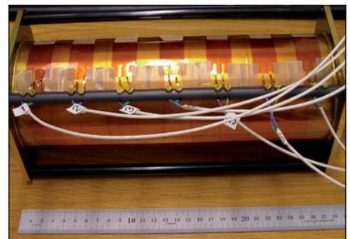
Messung der Temperaturverteilung an einem im BEV angefertigten Prototypen eines Shunts für 100 A
