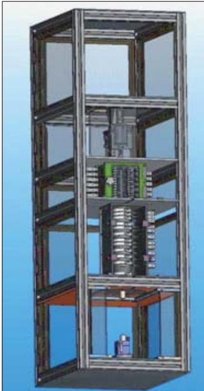
Konzept und Konstruktion der 10 N Totlastmaschine
