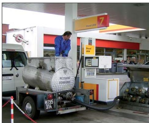
Überprüfung einer LKW-Betriebsstoffmessanlage
