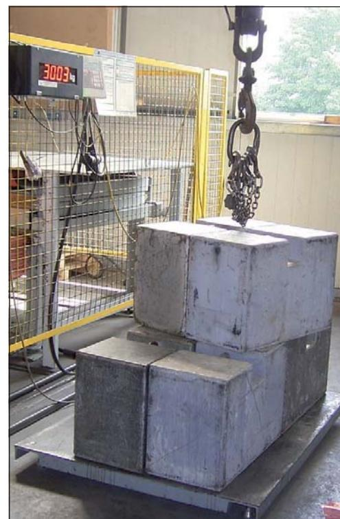
Überprüfung einer Handelswaage
