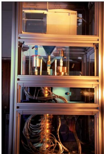
Realisierung der Balkenwaage, Seitenansicht mit Waagengehänge und Gewichtseinhausung links; Gegengewichte Mitte
