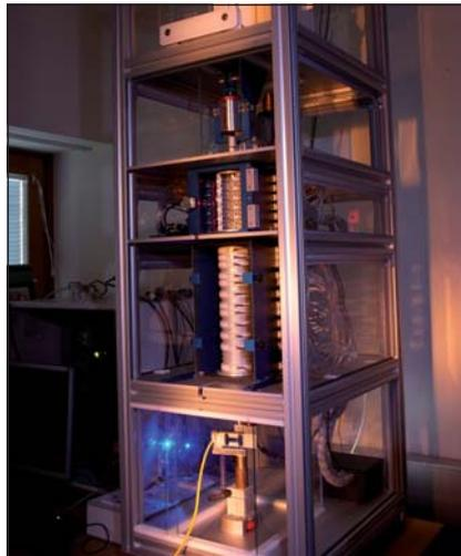
Realisierung der Totlastmaschine (ohne Einhausung); zwei Gruppen der Gewichte (Drahtgewichte oben und Scheibengewichte in der Mitte) bzw. deren veränderbare Halterungen sind sichtbar. Unten befindet sich die Messzelle mit einem 3 N Transfornormal, obenauf die Komparatorwaage
