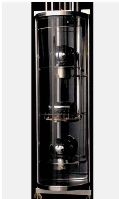
Messzelle zur Bestimmung der Festkörperdichte
