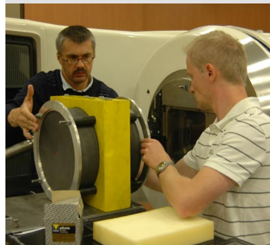
Abb.2 DI Steuer und DI Baumgartner bei der Positionierung des Graphit-Phantoms vor dem Strahlerkopf des Linearbeschleunigers
